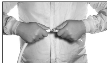
ABBILDUNG 3. BEFESTIGUNG DER ABNEHMBAREN SPITZE AM GLASFASERKABEL
